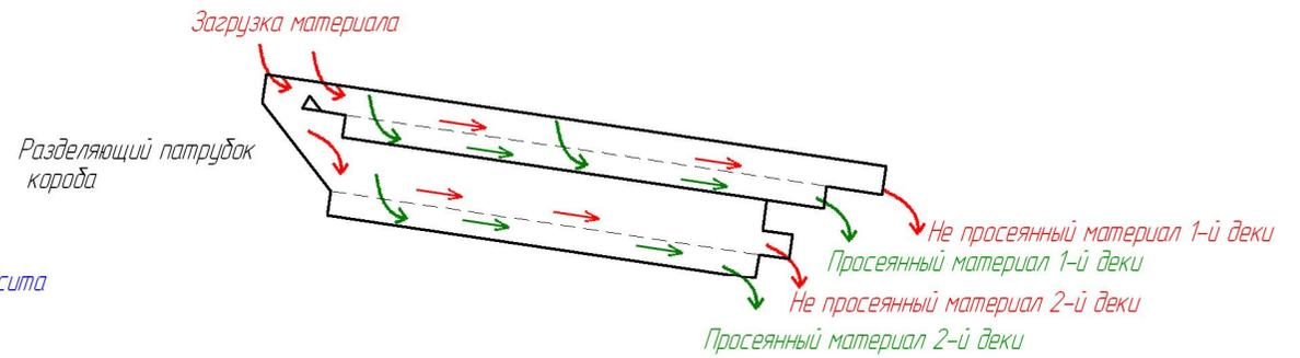
*Короб с двумя деками, с обратным движением потока материала.*
